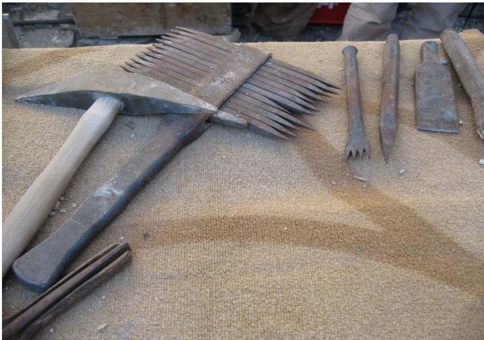
Spaltkeil, Spitze, Fläche, Zahneisen, Meißel, Scharriereisen, von der Antike bis in die Jetztzeit Werkzeug des Steinmetzen. Abb. 26
