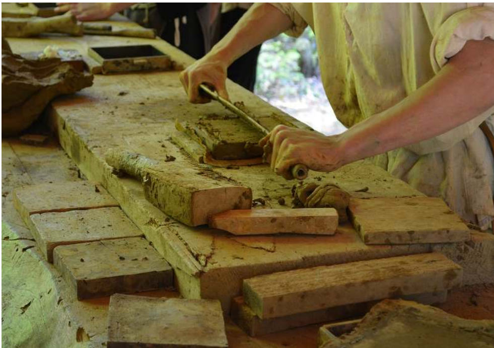
Abb. 35 Ziegelfußbodenfertigung, Wikipedia Skouame 2014
