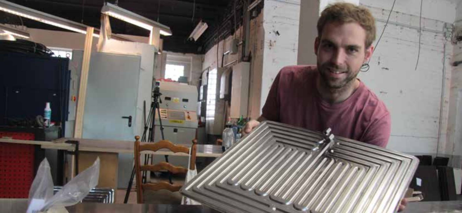
Oliver Baum mit seiner einfachen, aber effektiven Erfindung, einem Wärmetauscher für die Duschwanne. Foto: Michael Eberstein
